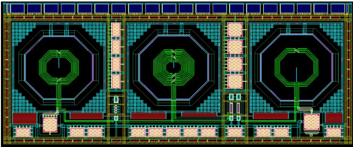
Figure 43: Layout of LNA 1
