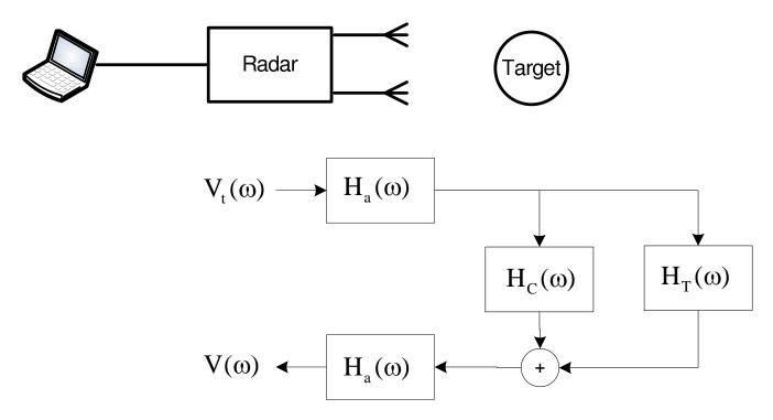
$V_{T}(\omega) = V_{t}(\omega)H_{a}^{2}(\omega)[H_{C}(\omega) + H_{T}(\omega)]$
